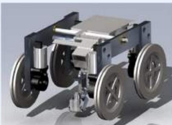
Il sistema Ragno è stato realizzato nel 2010 e permette di misurare lo spessore delle pareti interne di serbatoi (interrati e non) per determinarne lo stato di conservazione senza che gli operatori debbano entrare al loro interno. Il robot motorizzato, montato su ruote magnetiche e dotato di una sonda ultrasonica con doppia lettura di 10
