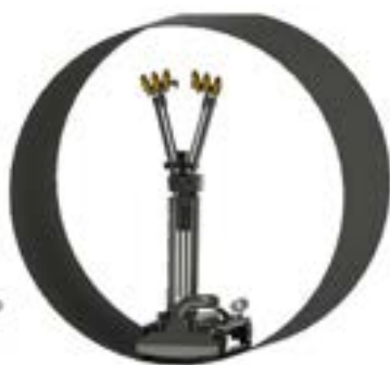
➔ BRUCO 3.0 all'interno di un serbatoio del diametro di 1.500 mm.
